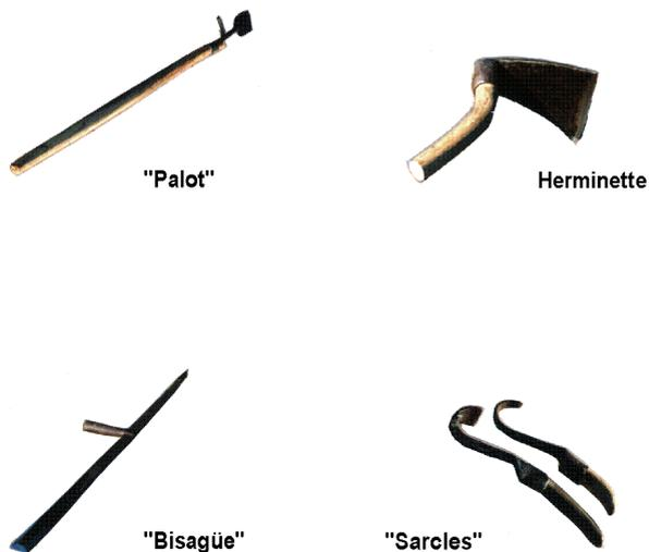
Fig. 97. Outils traditionnels utilisés pour le façonnage de la première reproduction de la pirogue 18.
