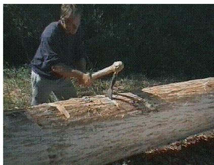
Fig. 101. Façonnage du fond de la pirogue à la hache.
