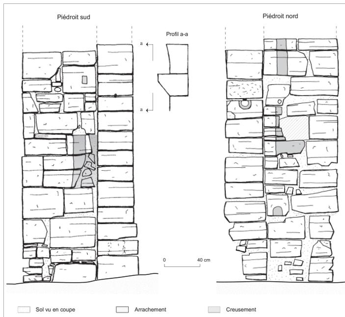
Fig. 17. Élévation des piédroits de la porte du Datter.
