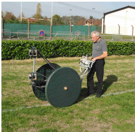
Fig. 4. Chariot expérimental conçu par M. Martinaud pour améliorer la qualité des prospections magnétiques (cl. V. Mathé).
