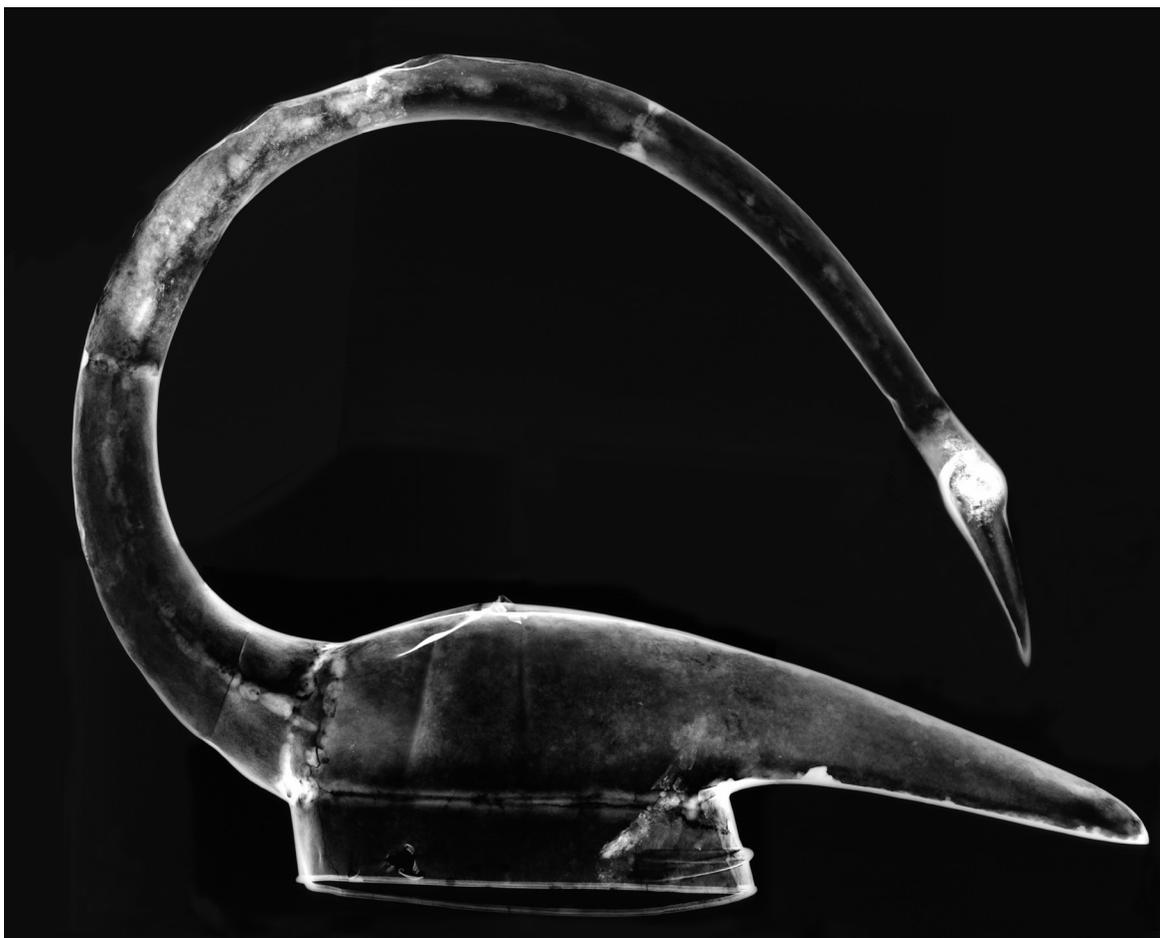
Fig. 74. Cliché radiographique du casque 468 montrant les différentes brasures et sections (cl. C. Gargam et Apave-l'Union).
