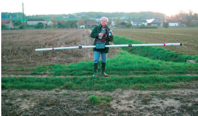
Prospection électromagnétique en 2004 par la méthode slingram (EM 31) pour la mesure de la conductivité apparente du sol dans les six premiers mètres.
