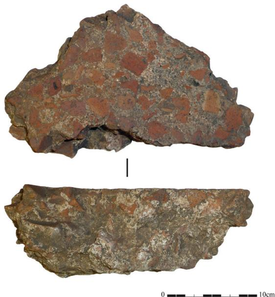
Fig. 9. Fragments de sol de béton de tuileau de la phase 2b2 (cl. et DAO P. Péfau).
